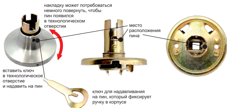
Способ снятия накладки
